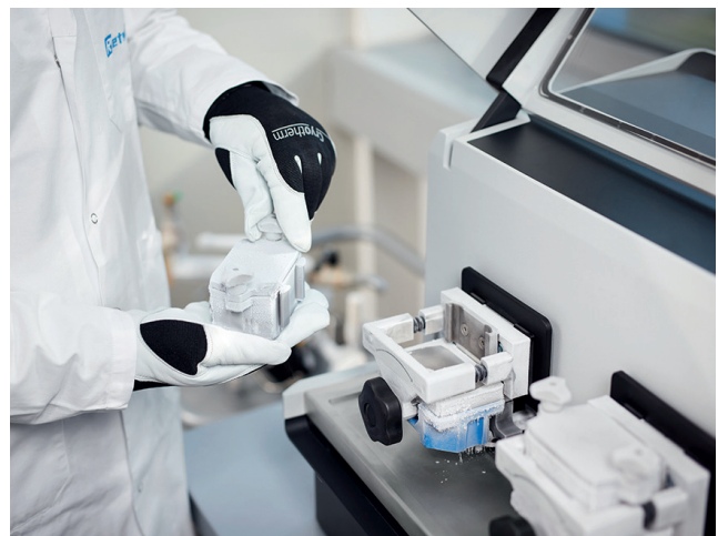
Figura 2: Concepto de refrigeración basado en placas térmicas; la muestra se procesa en recipientes de bloqueo por tornillo -Screw Lock Jars- que son montados sobre las placas térmicas
