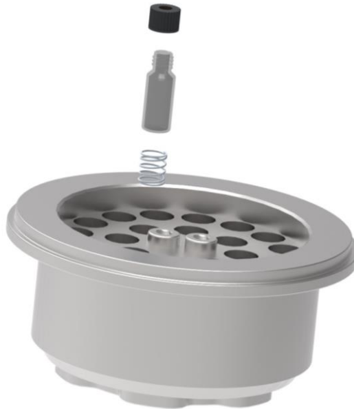
III. 65: Vue éclatée de l'adaptateur avec ressort de pression et récipient de 1,5 ml
