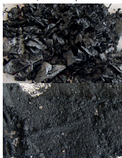
ポリマー箔 クライオミル 10 mm / < 800 μm
