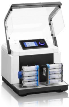
Abb. 1: Schwingmühle MM 400 mit Adapter für Zentrifugalröhrchen zur simultanen Zerkleinerung von bis zu 8 Proben, z. B. als Probenvorbereitung für das Potency Testing.
