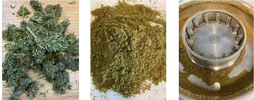
Abb. 7: Cannabisblüten vor der Vermahlung und nach der kryogenen Vermahlung in einer Kugelmühle (Mitte) (insgesamt 4 min für 20 g Probe) oder in der ZM 300 (10 min für 500 g Probe, rechts).
