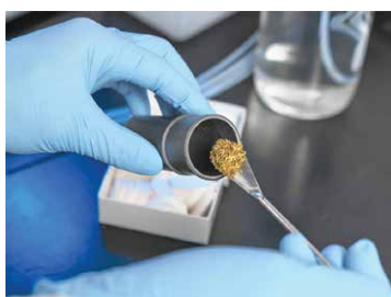
Abb. 2 - oben: Extraktionssystem EDGE; unten: Einfüllen der homogenisierten Probe in das Q Cup vor der Extraktion
