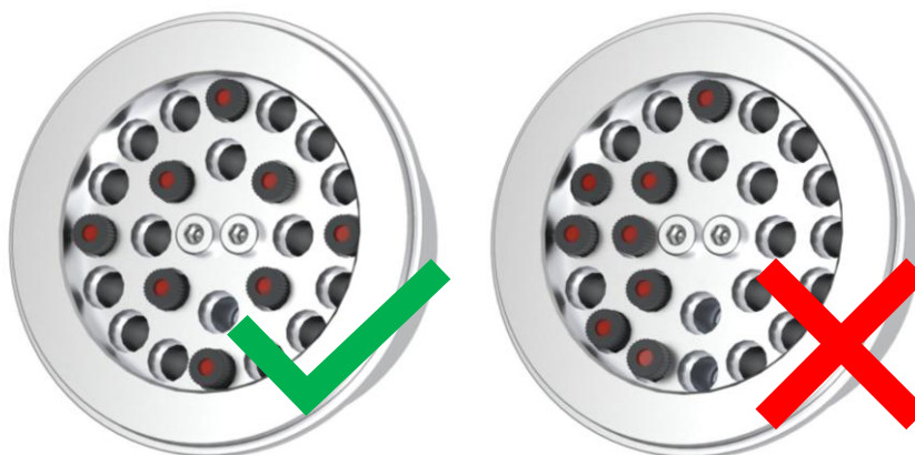
Рис. 35: Допустимое расположение стеклянных емкостей в адаптере
