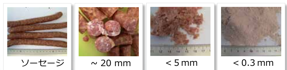
図3：ソーセージのホモジナイズ：左から順に、粉碎前、手作業でカットしたもの、5mm以下に粉碎したものの、300µm以下に粉碎したものの
