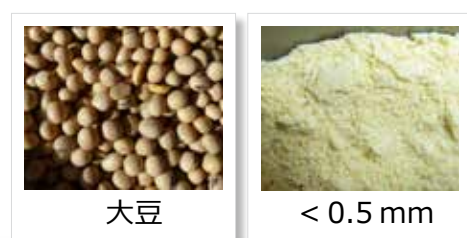
図11：大豆のホモジナイズ。 左：粉砕前、右：500 \mu m以下に粉砕した試料
