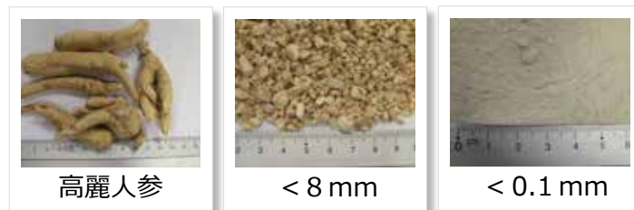
図8: 高麗人參の粉碎; 左: 粉碎前 中: 8mm以下に粉碎した試料 右: 100 \mu m以下に粉碎した試料
