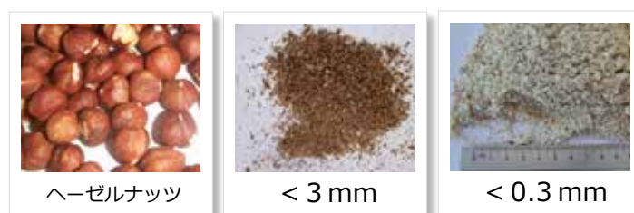
図5：ナッツのホモジナイズ：左から順に、粉砕前。3mm以下に粉砕した試料；300 \mu m以下に粉砕した試料
