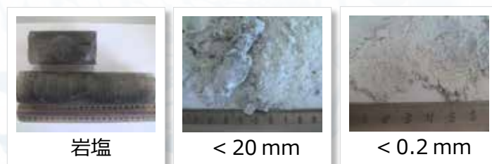
図9: 岩塩の粉碎。左から順に、粉碎前、20mm以下に粉碎した試料、200 \mu m以下に粉碎した試料。
