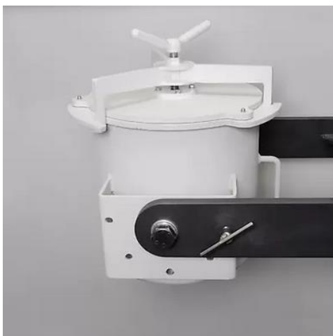
Abb. 19: Mahltrommel mit geschlossenem Deckel
