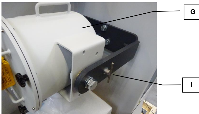
Fig. 10: Fissaggio del tamburo di macinazione con vite di fermo
