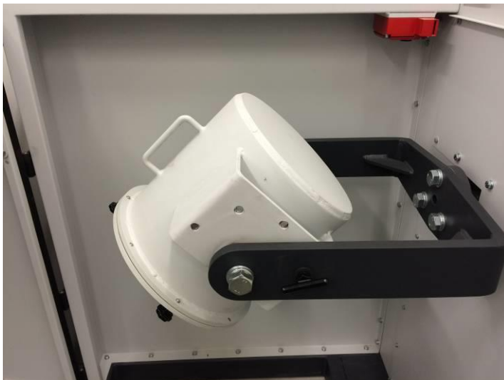
Fig. 24: Tamburo di macinazione in posizione di svuotamento
