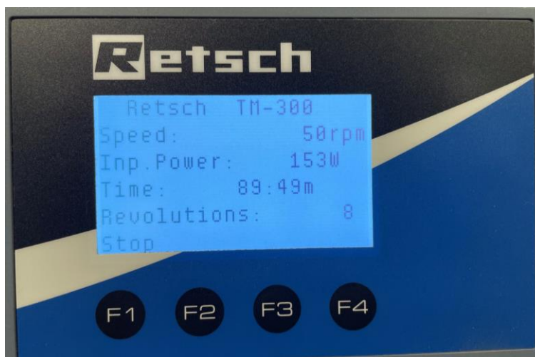
Fig. 42: Display durante il processo di macinazione, Stop on: Time
