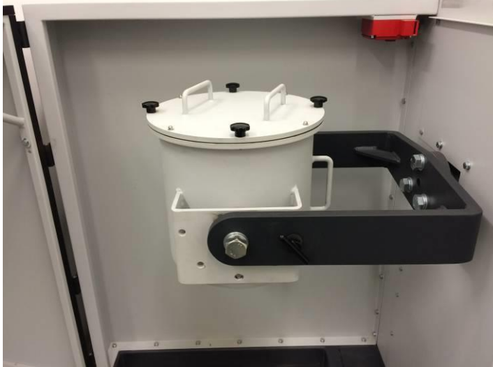
Fig. 16: Tamburo di macinazione (21,7 litri) in posizione di riempimento
