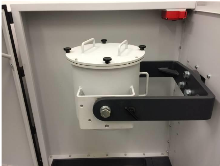
Fig. 21: Tamburo di macinazione in posizione di riempimento
