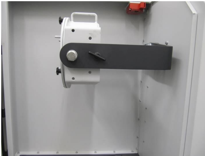
Fig. 12: Modulo a sfere da 5 litri
