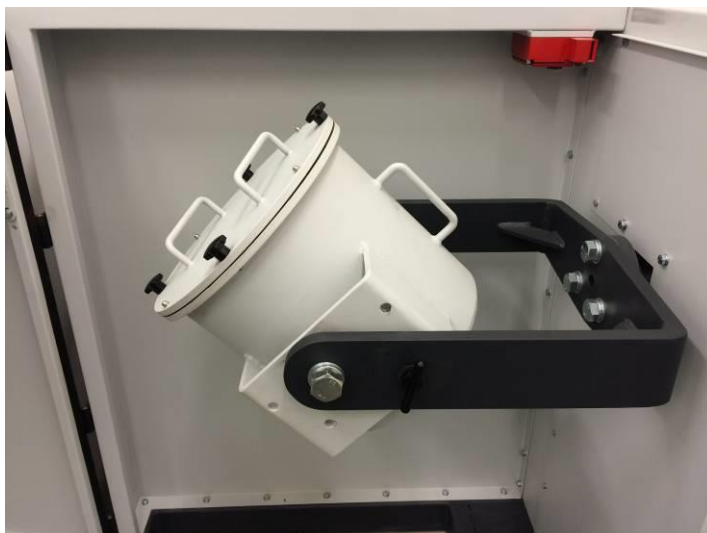
Fig. 22: Tamburo di macinazione in posizione di miscelazione
