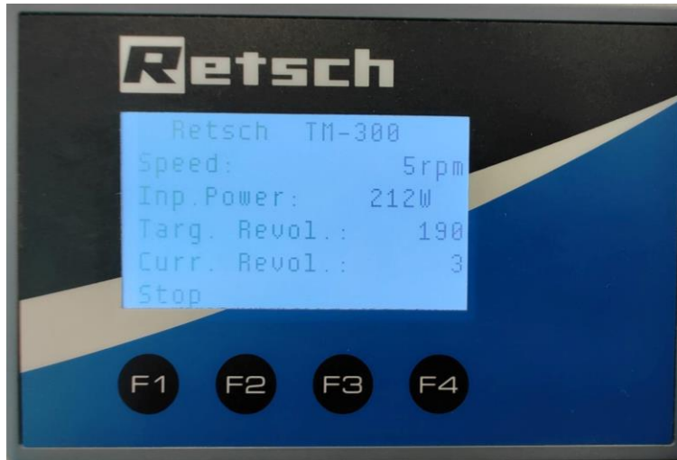
Fig. 41: Display durante il processo di macinazione, Stop on: Revolut
