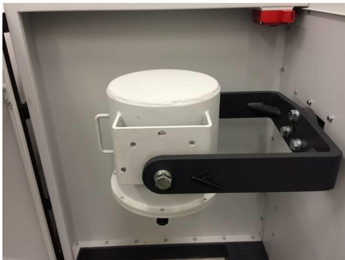
Fig. 25: Tamburo di macinazione in posizione di svuotamento completo
