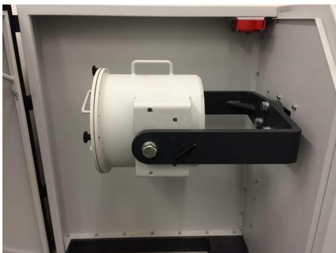
Fig. 14: Modulo a sfere da 21,7 litri
