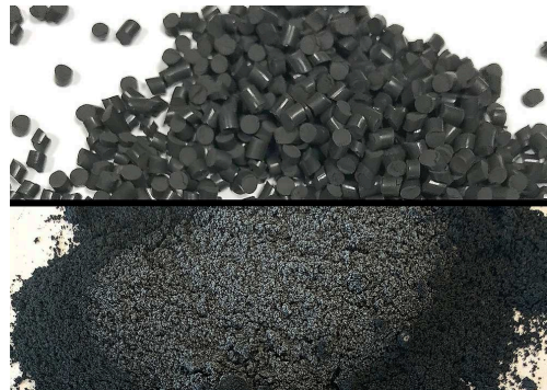
Broyage rapide de caoutchouc noir de type Fluorocarbure (FKM) en fragilisant l'échantillon dans deux bols de 125 ml à - 100 °C.
