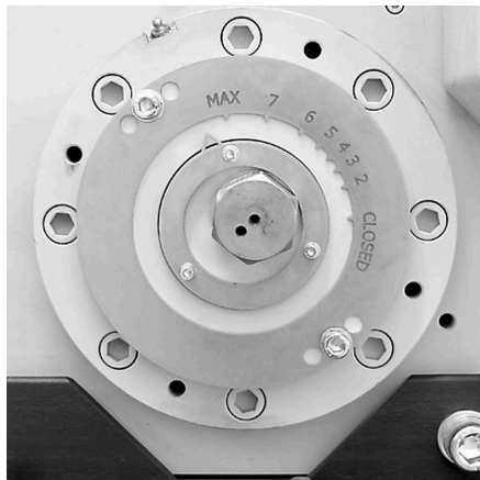
Escala para el ajuste continuo de la abertura de salida
