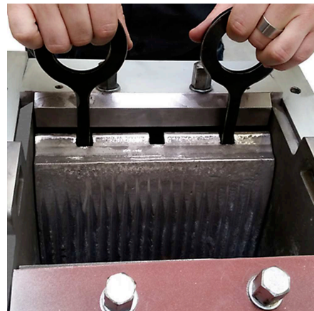
Mandíbulas y chapas antidesgaste reemplazables
