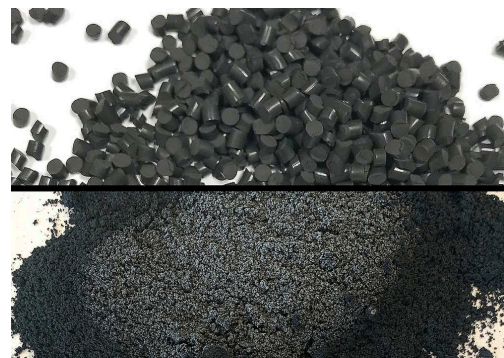
黒色の炭化水素ゴム（FKM）を125ml×2 粉碎ジャーに投入し、-100°Cの環境下で高速粉碎する。
