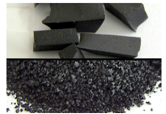
タイヤ (ゴム) ドライアイス、液体窒素を 使った凍結粉碎方法
