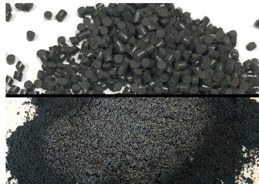
通过将样品放置于两个125mL研磨罐中，-100 °C冷冻脆化，实现黑色氟碳橡胶（FKM）快速研磨粉碎。
