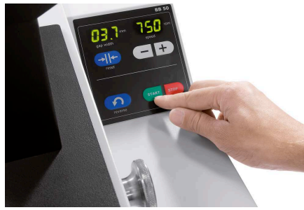
Setarea digitală a vitezei și afișarea distanței dintre fălci
