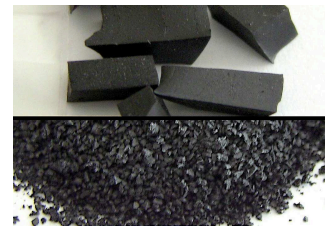
guma z opon Rozdrabnianie kriogeniczne
