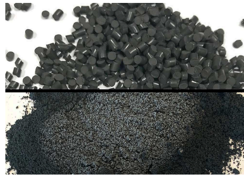
Măcinarea rapidă a cauciului negru Fluorocarbon (FKM) prin fragilizare în două incinte de 125 ml la -100 °C.
