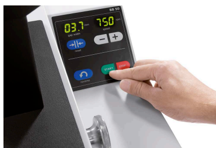
Digitálne nastavenie rýchlosti a zobrazenie šírky medzery
