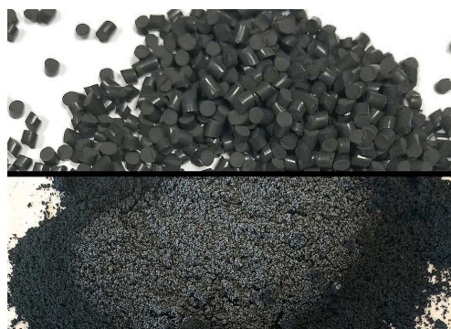
Moagem rápida de borracha de fluoroelastômero preto (FKM) fragilizando a amostra em dois frascos de 125 ml a -100 °C.
