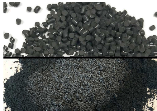
Fekete fluoroelastomer (FKM) gyors őrlése -100 °C-ra való hűtéssel két 125 ml-es őrlőedényben.
