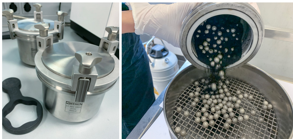
Abbildung 2: links: befüllte PM 300-Mahlbecher mit Sicherheitsverschluss rechts: Entleeren der Mahlbecher nach abgeschlossener Vermahlung.
