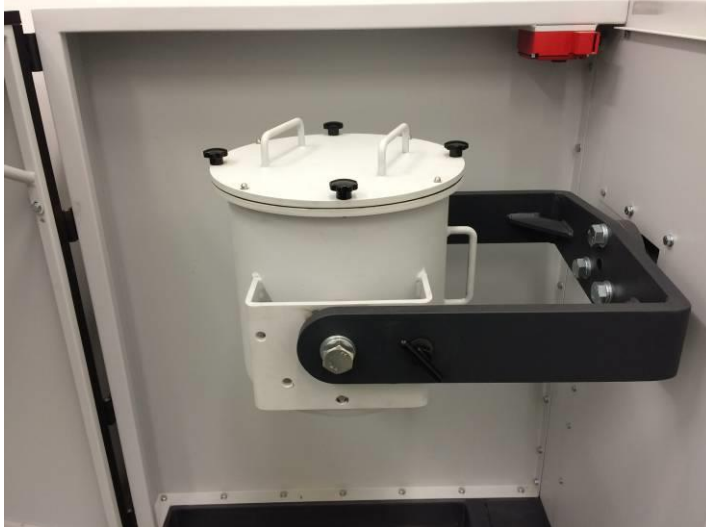
Рис. 16: Размольный барабан (21,7 л) в положении заполнения
