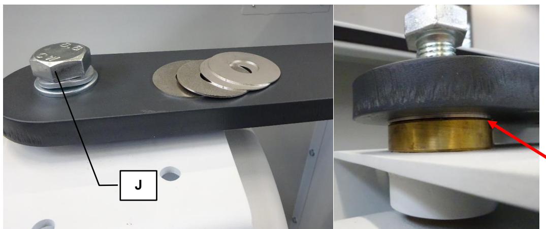
Рис. 11: Выровняйте зазор между размольным барабаном и креплением размольного барабана
