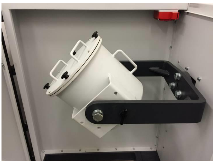
Рис. 22: Размольный барабан в положении смешивания
