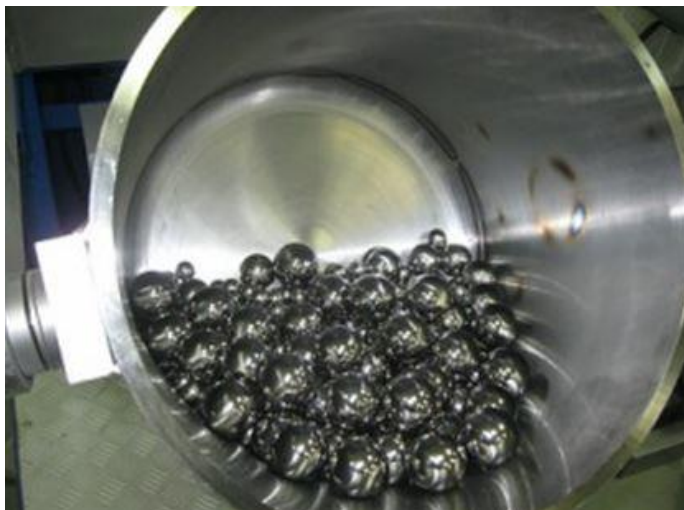
Рис. 17: Размещение размольных шаров
