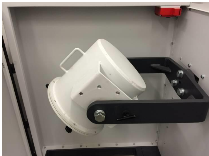
Рис. 24: Размольный барабан в позиции опорожнения
