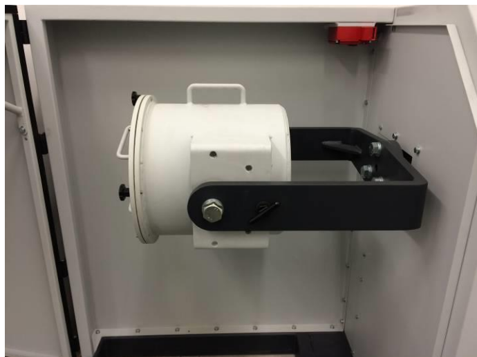
Рис. 14: Шаровой модуль 21,7 л
