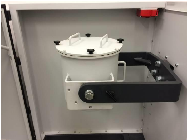
Рис. 21: Размольный барабан в положении заполнения
