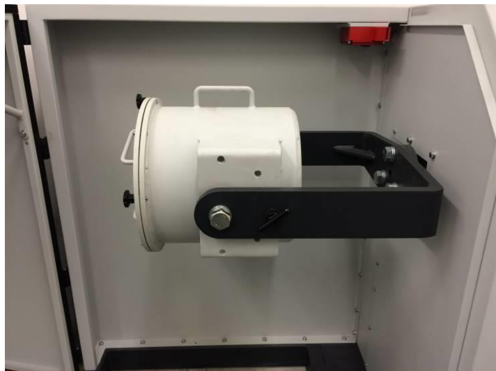
Рис. 23: Размольный барабан в позиции размола
