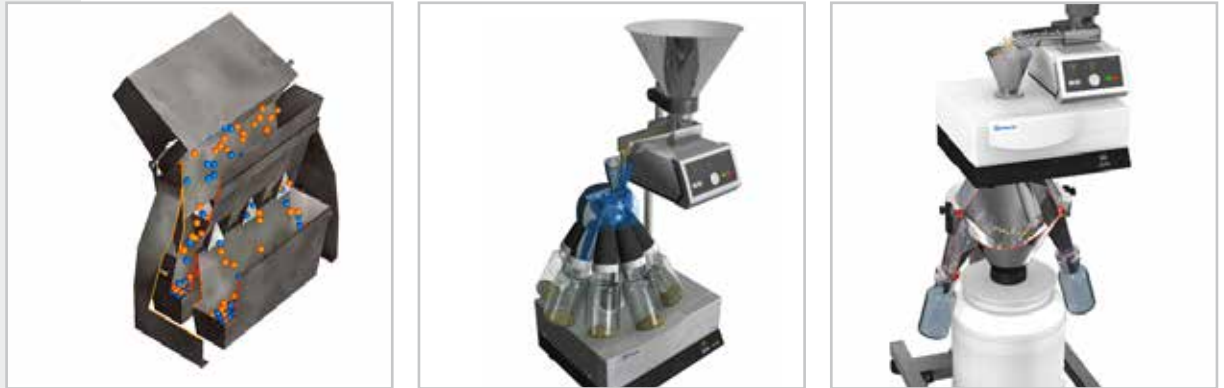
Abb. 3: Funktionsprinzipien eines Riffelteilers (links), Rotationsprobenteilers (Mitte) und Drehrohrteilers (right)
