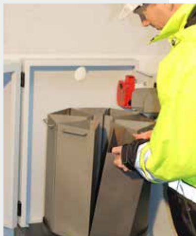
Abb. 9: Bis zu 60 l Probe können im PT 600 aufgegeben werden (oben); Entnahme des 6 l Teilersegments (Mitte); Modul mit 8 Teilersegmenten (unten)
