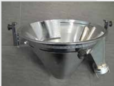
Abb. 8: Unterkonus des PT 200 mit einem Auslass. Die Schlitzweitenskala reicht von 0 bis 170 mm.
