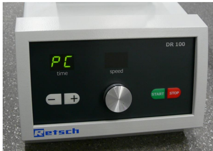
図30: ZM 300で制御している時の供給機のディスプレイ表示
