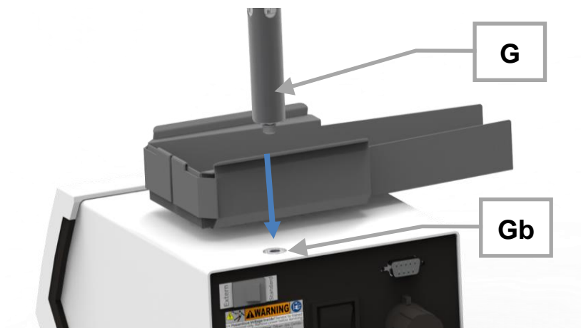
図13: ロート保持具用ロッドの装着
