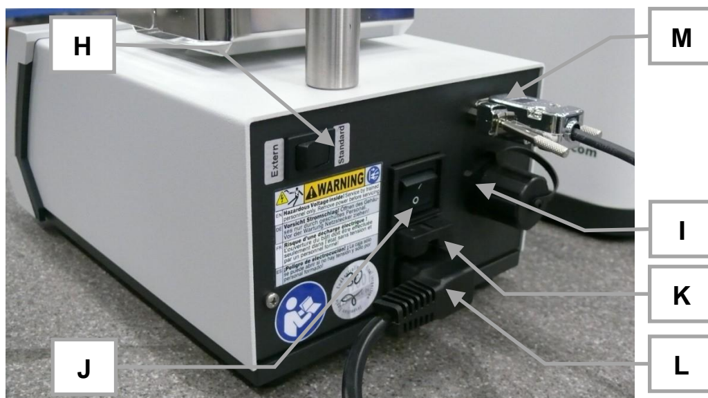
図4: 装置本体の背面にある、電源接続とインターフェース
