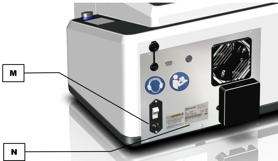
図12：電源への接続
